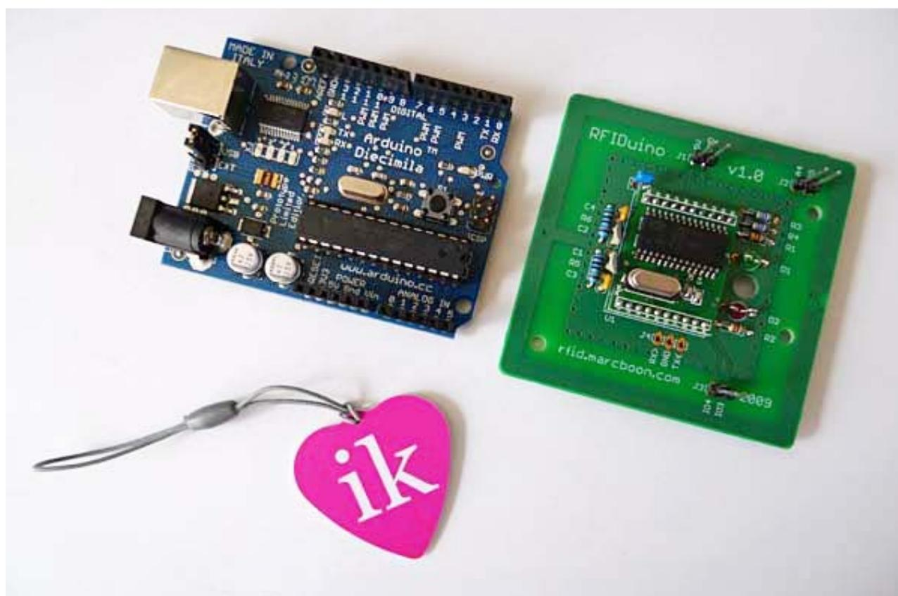
Fig. 1 - [Arduino Diecimila](#) with [RFIDuino](#) and [ikTag](#) (Mifare 1K RFID tag)
